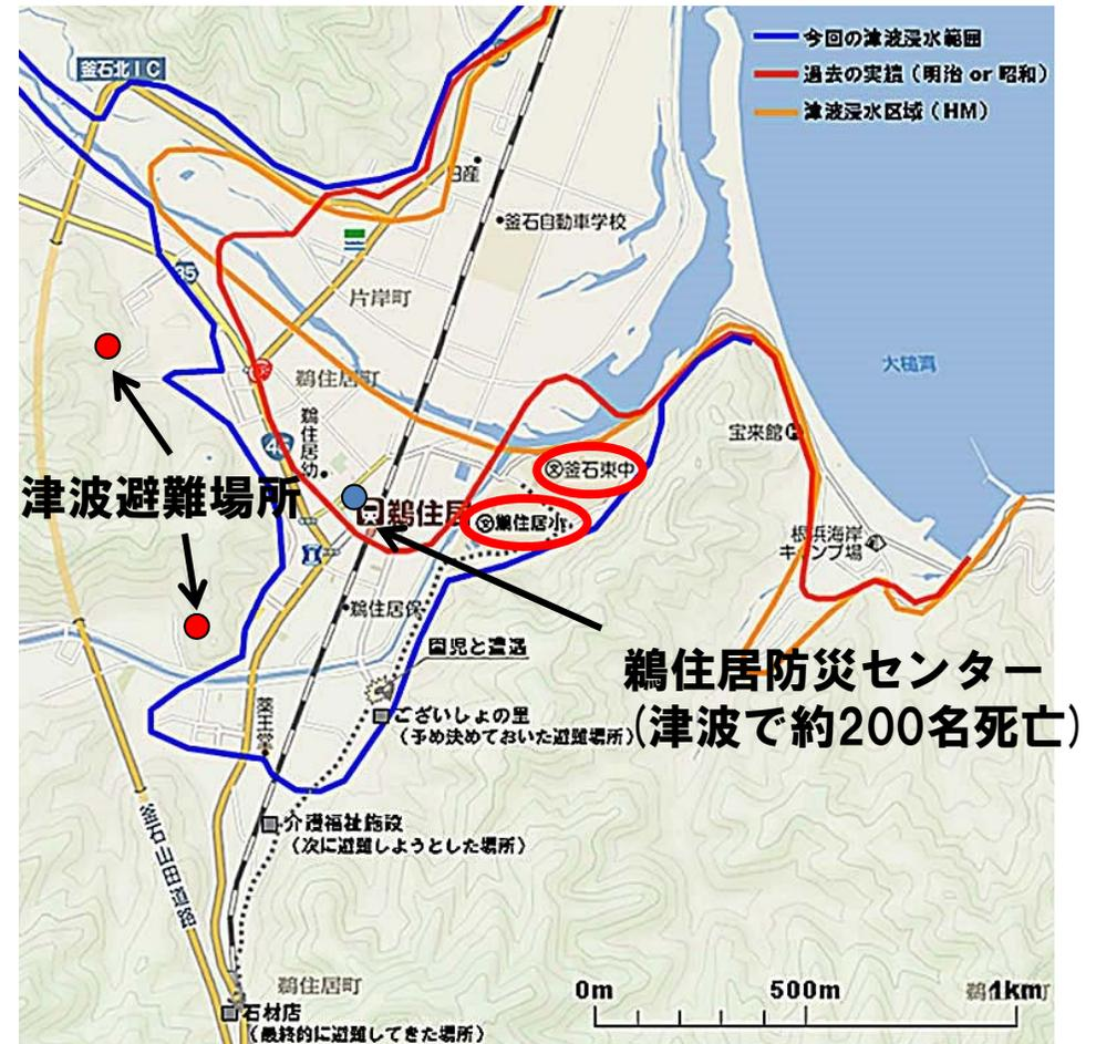
釜石市・鵜住居(うのすまい)地区における過去の地震の実績、ハザードマップ、東日本大震災時の津波浸水域、および「釜石の奇跡」による避難経路(片田研究室)
