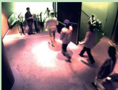
避難訓練におけるステレオカメラを用いた人流の計測(北九州)
