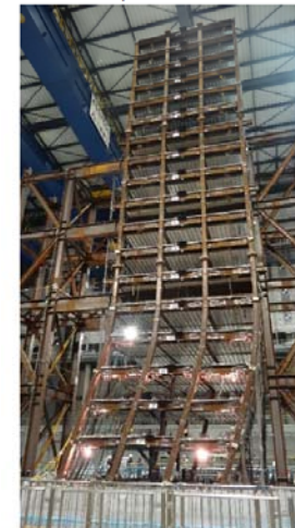
最終崩壊形(試験体は倒壊して防護フレームに寄りかかっている)
