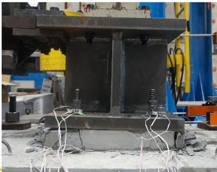
既往の露出柱脚の設計指針式は大幅に耐力を過大評価
