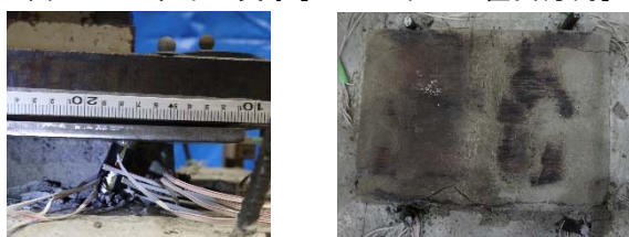
(d) アンカーボルト破断 (e) モルタル表面[実験後]
