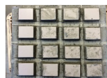
c) モルタル切削後
