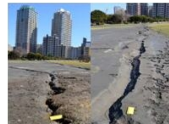
液状化(亀裂)の事例 (千葉県幕張海浜公園)
