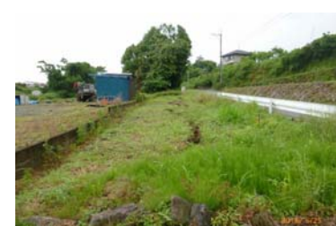
敷地南面の地表地震断層による亀裂
