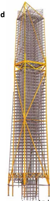
mega-braceによるエネルギー吸収型の外郭構造
