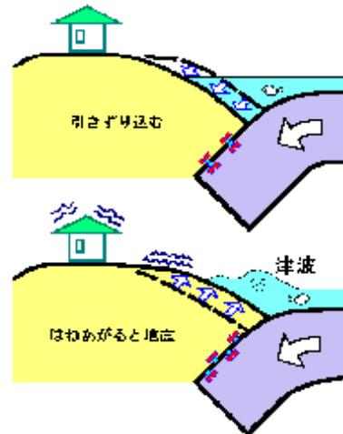
図 12 海のプレートの沈み込み(海溝型地震)による地震と津波の発生
