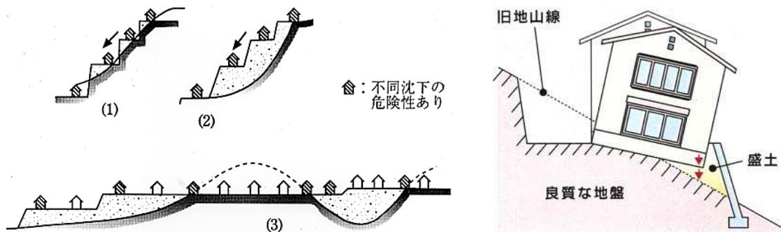
図 27 切土・盛土による宅地造成（左）、盛土の斜面崩壊による建物の被害（右）
