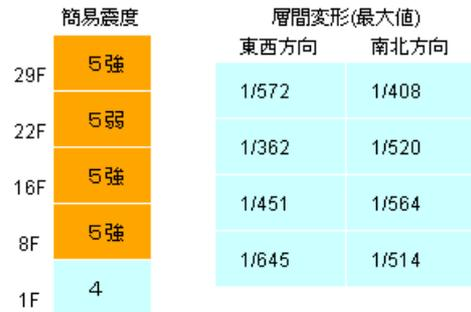
図21 2013年東日本大震災時の工学院大学新宿校舎における即時被災度判定システムによる表示結果
