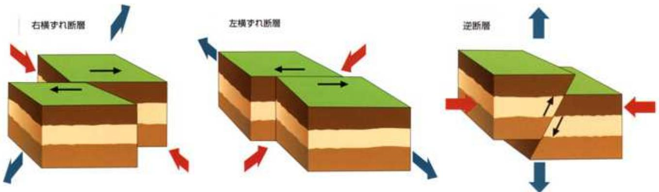
図 10 断層運動の種類（正断層は逆断層と逆向きにすべる、<http://www.jishin.go.jp/main/mech/1-4.htm>）
