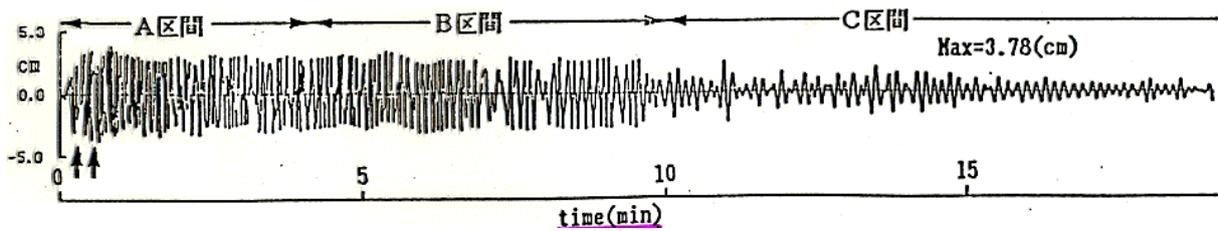
図 28 今村式 2 倍強震計による 1923 年関東地震の東京都本郷における変位波形
