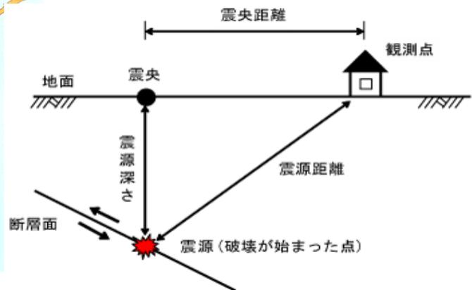
図 14 震源と震央、震源距離と震央距離、
