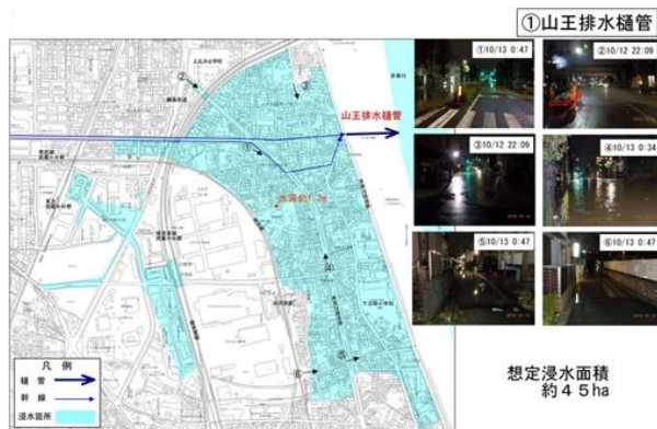
図2 山王排水樋管からの逆流
