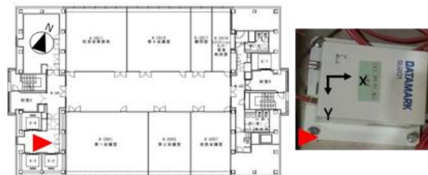
図 6 地震計の設置方向
