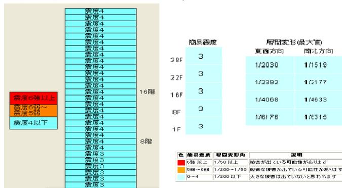
図4 地震応答表示システム(左)とリアルタイム観測システム(右)の結果の比較(駿河湾の地震)
