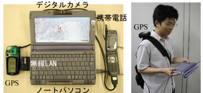
写真 1 現地被害情報把握システム(左:ハード、右:装着例)
