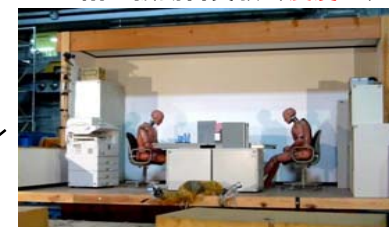
1階の振動台実験(震度6弱)
