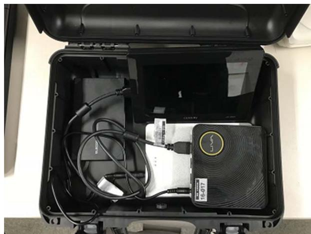
図 4 防水キャリングケースへの実装（固定前）
