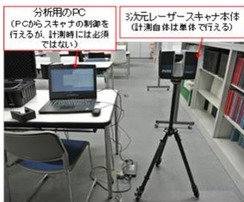
図1 3次元レーザースキャナの全体構成図
