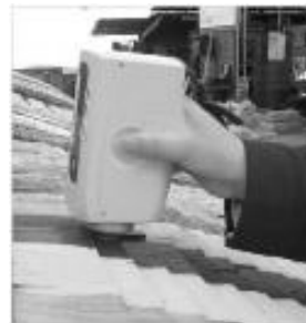
写真2 こけら板の測定状況 図3 L*a*b*表色系の概念図
