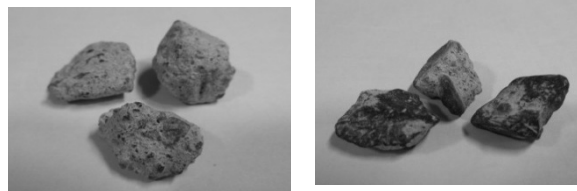
a) 附着ペースト骨材 b) モルタル塊 写真2 再生骨材 M
