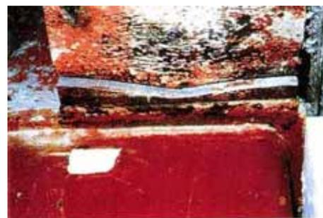
図10 完全溶込破断<sup>3)</sup>
