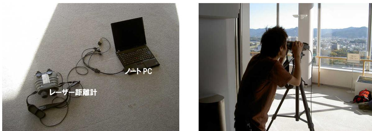
図 3-18 被害情報収集システムの構成（左）および実験の様子（右）（実験 2）
