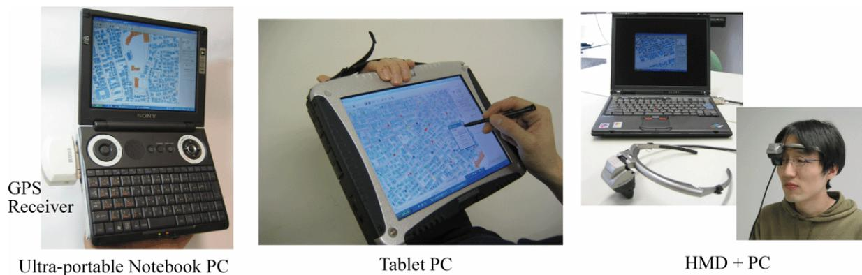
図 3-17 被害情報収集システムの構成例（上段）および実験の様子（下段）（実験 1）
