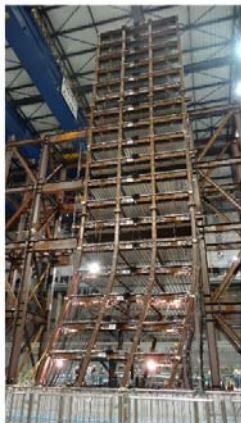
最終崩壊形(試験体は倒壊して防護フレームに寄りかかっている)
