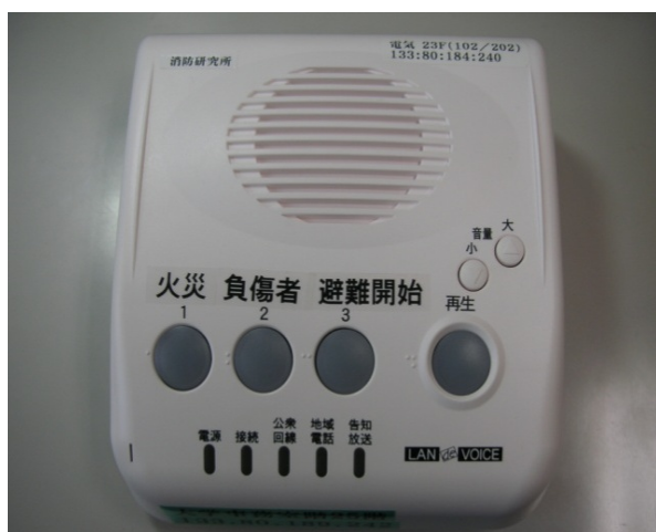
図4 緊急通報システム (ボタン名など変更の予定)
