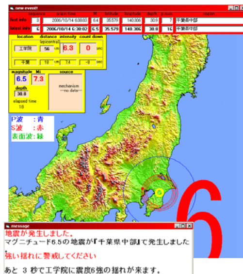
図3 緊急地震速報(左)とリアルタイム地震観測システム(右)の画面例
