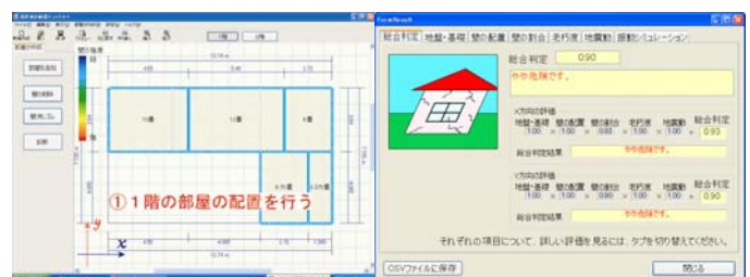
図2 簡易耐震診断入力例
