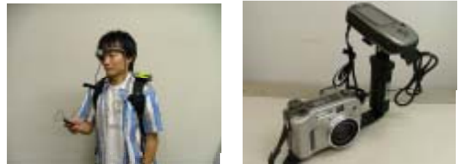
写真3 左:ウェアラブルPC 右:GPSカメラ
