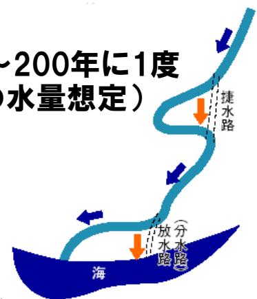
放水路と捷水路
