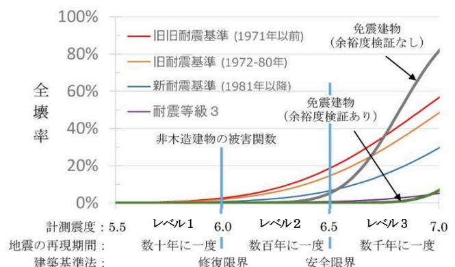
図10 非木造建物（RC/S造）の建築年別の全壊率とレベル別の耐震設計の概念図<sup>9)</sup>
