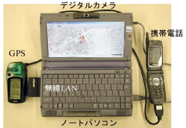
写真1 現地被害情報収集システムのハードウェア例
